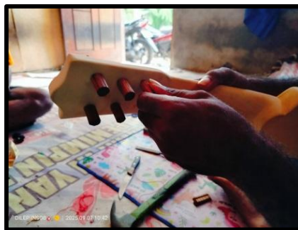
Gambar 35. Memasang Tuner Pada Bagian Kepala Ukulele
