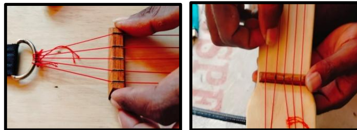
Gambar 37. Pemasangan Nut dan Saddle Pada Ukulele Sumber: Koleksi Peneliti
