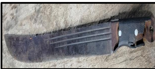
Gambar 4. Alat Potong Berupa Parang Panjang Untuk Memilah Kayu Yang Tidak Dibutuhkan Dari Bagian Ukulele Sumber: Koleksi Peneliti
