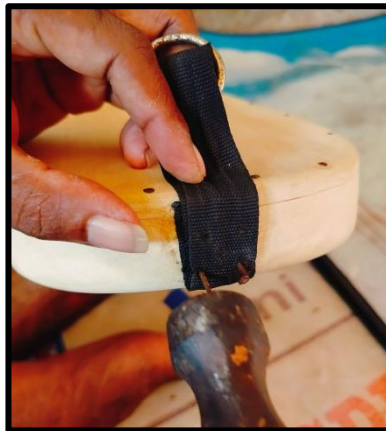
Gambar 34. Memasang Potongan Ikat Pinggang dan Besi Berbentuk D Pada Badan Ukulele
