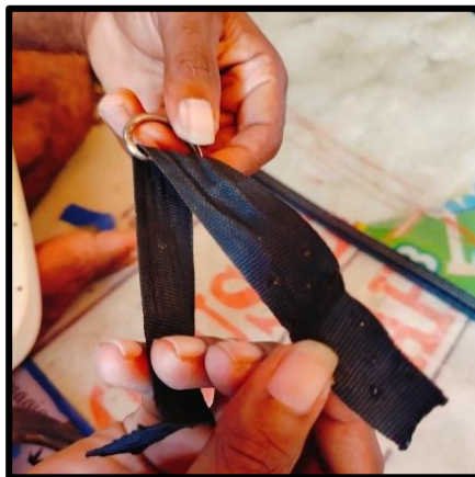
Gambar 33. Menyisipkan Potongan Ikat Pinggang Kedalam Besi dengan Motif "D"
